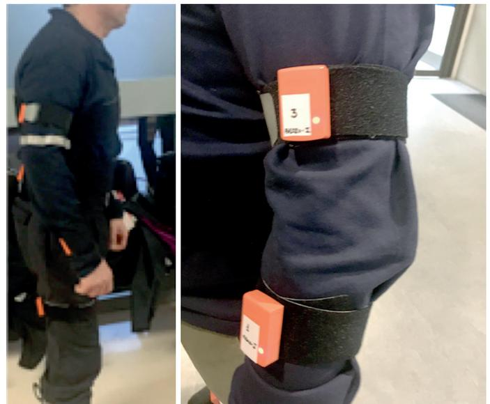
Figura 1. Distribución real de los sensores inerciales.
